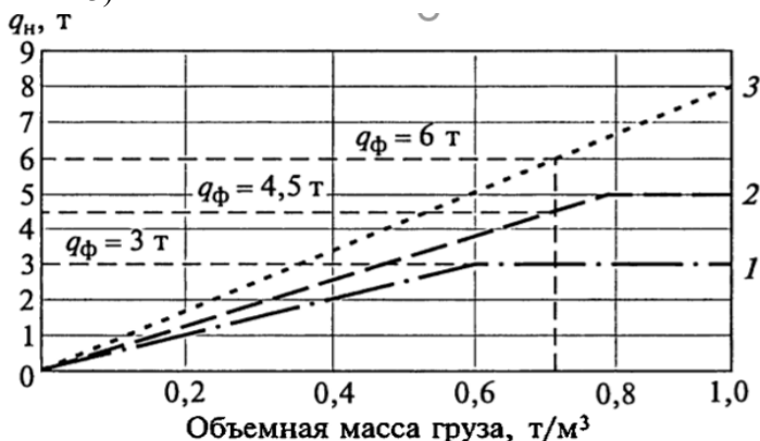
Рисунок 7.1. График использования ПС разной грузовместимости: 1) q_n = 3 т, q_\phi = 3 т; 2) q_n = 5 т, q_\phi = 4,5 т; 3) q_n = 8 т, q_\phi = 6 т.
